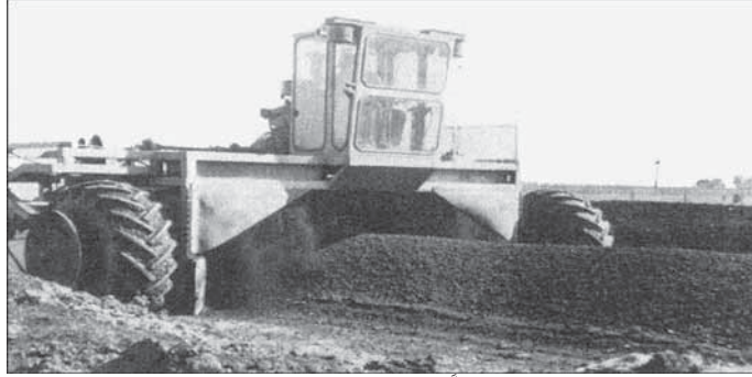
شكل 11-60: آلة تحويل إلى سماد مخلّط في صفوف مصدّات ريحية لمزجه و متراكمة في صفوف ذات شكل مثلي
